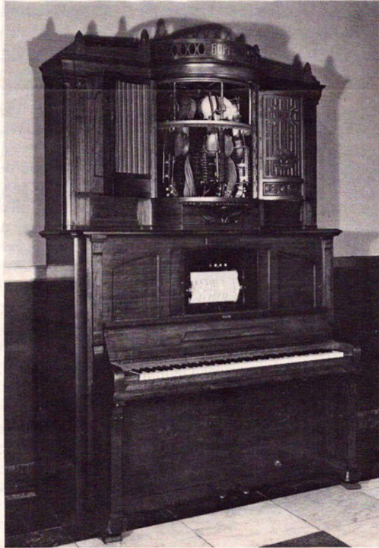
De Hupfeld Phonoliszt Violina. Een automatische piano met drie automatisch spelende violen. De papieren rol „bespeelt” het instrument.
