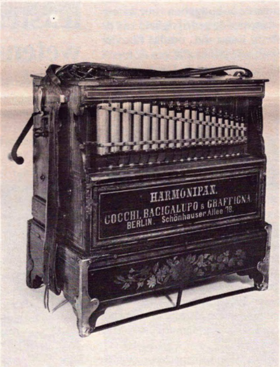
Het Bacigalupo-buikorgel (Berlijn ca. 1890) met muziekprogramma van pinnen en bruggen op een houten cilinder.
